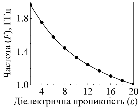
Рисунок 2.28 – Залежність частоти TM_{0,1,0} -моди від діелектричної проникності стрижневих зразків
