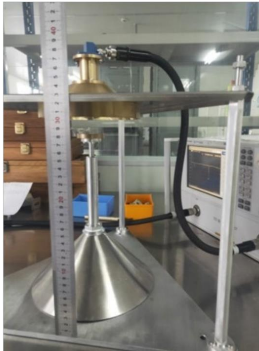
Рисунок 2.7 – Зовнішній вигляд експериментальної установки з відкритим напівсферичним резонатором, підключеним до Vector Network Analyzer через елемент зв'язку в сферичному дзеркалі
